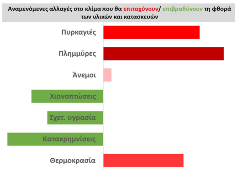
Σχήμα 1. Σχηματική απεικόνιση των αναμενόμενων κλιματικών μεταβολών που θα επηρεάσουν τη φθορά των υλικών και των κατασκευών στους υπό μελέτη οικισμούς του Ζαγορίου
