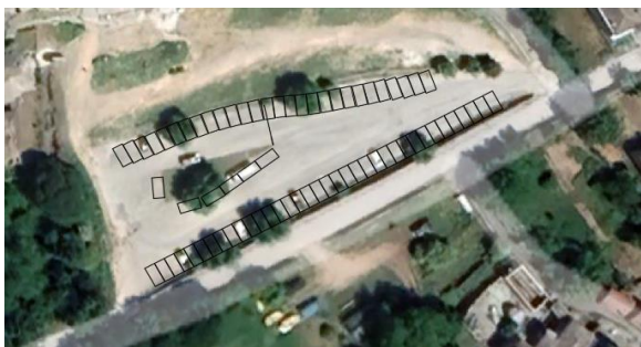
Εικόνα 75. Σκαρίφημα διαθέσιμων θέσεων εντός του χώρου στάθμευσης.
