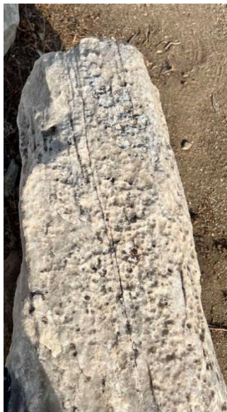
Εικόνα 30. Μαρμάρινο κιονόκρανο. Παρατηρείται διαλυτοποίηση και επανακαθίζηση ανθρακικού ασβεστίου ως κύρια φθορά
