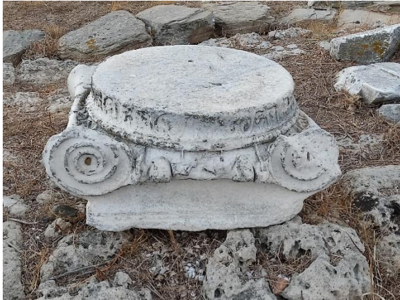
Εικόνα 30. Μαρμάρινο κιονόκρανο. Παρατηρείται διαλυτοποίηση και επανακαθίζηση ανθρακικού ασβεστίου ως κύρια φθορά
